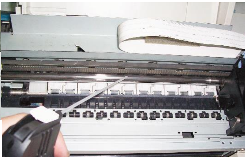
Fig. 1 Engranajes con dientes muy delicados, permiten la carga y desplazamiento de la hoja de papel.
